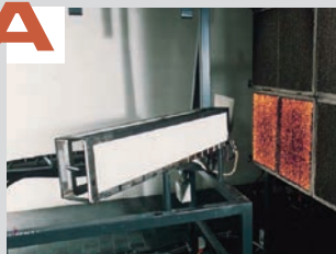
A) Inizio prova su MDF verniciato con un normale ciclo poliuretano.
