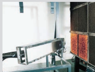
B2) Ha inizio la combustione ma la propagazione della fiamma è molto rallentata dalla verniciatura ignifuga.
