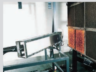
B3) La situazione è pressoché invariata, la zona danneggiata è minima e la fiamma tende a spegnersi.
