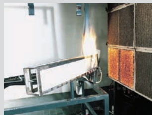
A2) La fiamma, senza protezione, raggiunge il legno.
