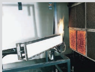
A1) Il calore di 750°C del pannello radiante incendia il film di vernice.
